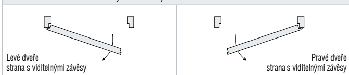
Směry otevírání – jednokřídlé dveře falcové
