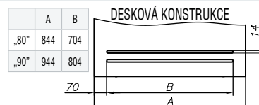
ventilační mezera v křídlech s deskovou konstrukcí - příplatek 589
