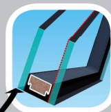
energeticky úsporné zasklení U3 (dvojsklo)
